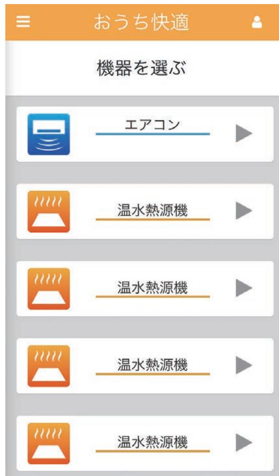
温水熱源機付エアコンを機器登録すると、「エアコン」に加えて、接続されている温水回路の数(最大4回路)の「温水熱源機」が登録されます。
