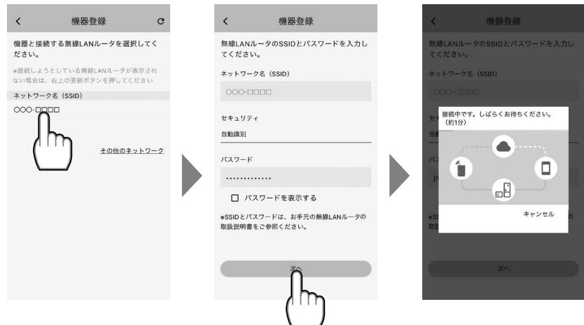
●「接続できませんでした。」と表示した場合は、「もう一度試してみる」をタップして再度 **19** の操作を行ってください。接続ができなかつたときは、エコキュートのブレーカと無線LANルータ両方の電源を一度切って電源を入れた後、アプリを終了させて再起動し、**4** からやり直してください。
