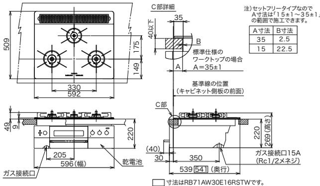
ビルトインガスコンロ 共通設置施工例図
