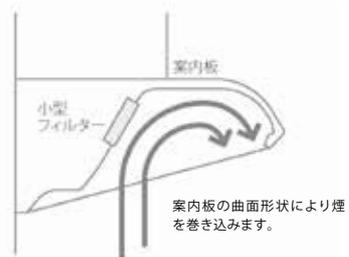
案内板の曲面形状によって、煙を「水平渦巻き状態」にキープしながら吸い込むことで、本体に入る手前でフィルターが油汚れを吸着する「フロントキャッチ方式」。
