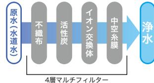
原水(水道水) → 不織布 → 活性炭 → イオン交換体 → 中空糸膜 → 浄水
