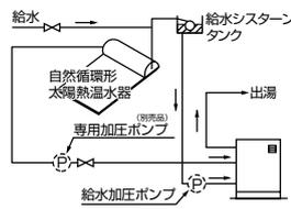
●自然循環形太陽熱温水器との接続の場合、専用加圧ポンプ(別売品)の取り付けが必要です。
