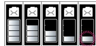
は点滅を表します。点滅したら給油してください。
