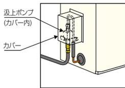
※油タンクと機器本体の落差がとれない(油タンクの灯油出口と、機器本体の設置床面位置が0.3m未満)ときに使用します。
