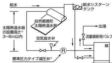
※太陽熱温水器と機器の落差は3m以上8m以下にしてください。
