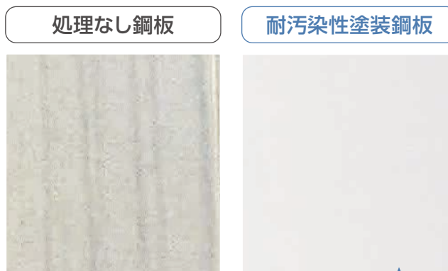
【貯湯ユニット外装写真】 耐汚染性試験比較(3ヵ月)
