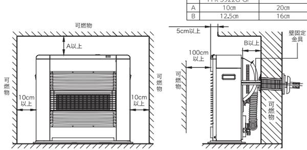
給排気筒トップから周囲の可燃物までの離隔距離
