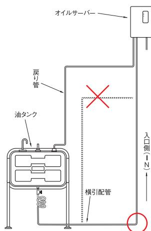
油タンクから1階燃焼機器へは自然落差、2階燃焼機器はオイルサーバーによる給油の場合は、配管の分岐を油タンク灯油流出口直下付近で行ってください。
