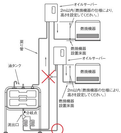
給油する燃焼機器の台数が多く、また、出口側配管長が20m以上の場合は、オイルサーバーをできるだけ中間に設置してください。このとき片側配管で15mを超えないようにしてください。
