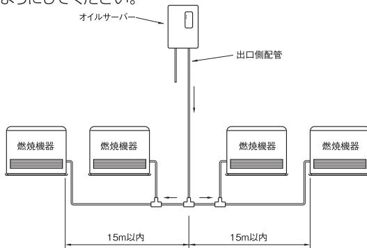
油タンク1基から数台のオイルサーバーに供給する場合は、必ず油タンク底面線より下で太い横引配管を取り各オイルサーバーに分岐してください。
