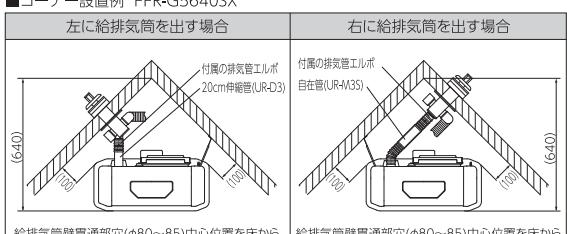
※図は設置の一例です。給排気筒の穴位置により使用する部材が変わります。延長設定や壁との固定、離隔距離などはストーブに付属の工事説明書に従ってください。
