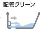
排水時にきれいな水(約5L)を自動的に流し、追いだき配管内を洗浄します。
