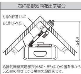
※図は設置の一例です。給排気筒の穴位置により使用する部材が変わります。延長設定や壁との固定、離隔距離などはストーブに付属の工事説明書に従ってください。他の設置例は54ページを参照ください。
