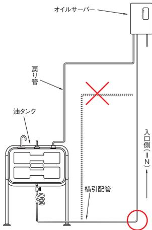
油タンクから1階燃焼機器へは自然落差、2階燃焼機器はオイルサーバーによる給油の場合、配管の分岐を油タンク灯油流出口直下付近で行ってください。燃焼機器近辺での分岐は、1階燃焼機器側への給油不足になり燃焼トラブルの原因になります。
