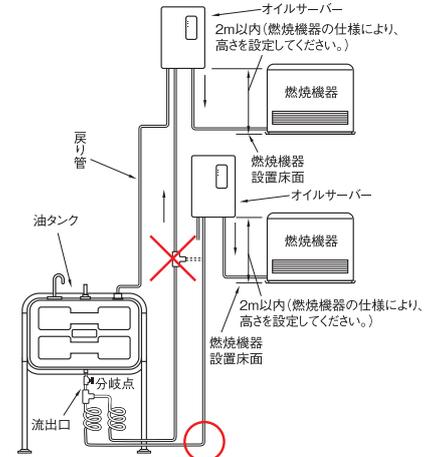
給油する燃焼機器の台数が多く、また、出口側配管長が20m以上の場合、オイルサーバーをできるだけ中間に設置してください。このとき片側配管で15mを超えないようにしてください。
