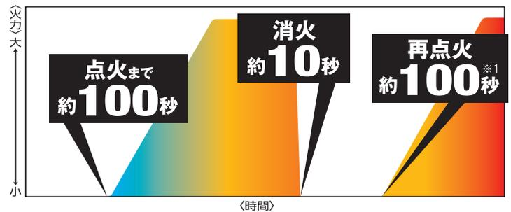
※室温・外気温により点火時間は変動します。※1 消火直後の再点火は、点火までに消火回路が働いている2分間がプラスされます。
