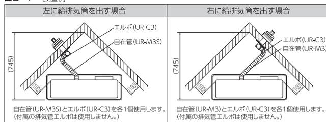
※図は設置の一例です。給排気筒の穴位置により使用する部材が変わります。延長設定や壁との固定、離隔距離などはストーブに付属の工事説明書に従ってください。※ストッパーリング2個、断熱カバーを必ずご使用ください。
