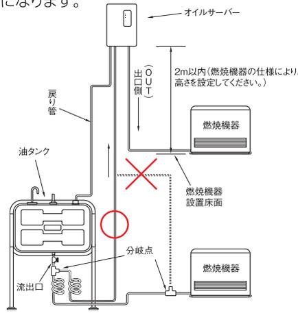
オイルサーバーを2台以上設置する場合は、立ち上がり配管途中での分岐をせずに、油タンク灯油流出口直下付近で行ってください。
