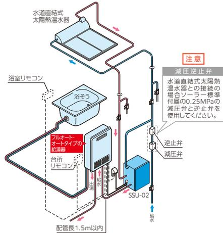
自然循環式太陽熱温水器 + ソーラー接続ユニット SSU-02P (ポンプ及び水用減圧弁内蔵タイプ)
