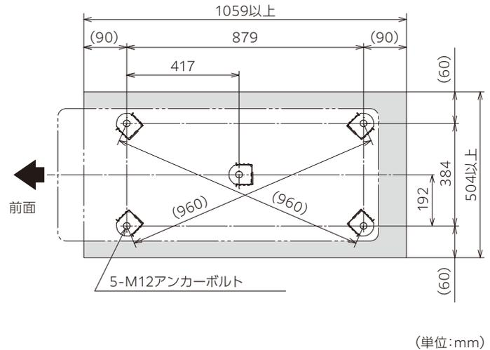
※アンカーボルトの位置がひし形にならないように、対角寸法が同じであることを確認してください。
