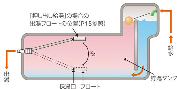
※ [ため出し給湯] の場合の出湯フロートの動き (P15参照)
