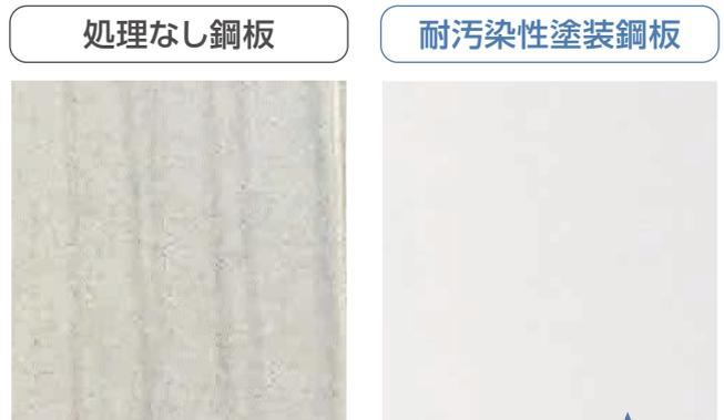
[貯湯ユニット外装写真] 耐汚染性試験比較(3ヵ月)
