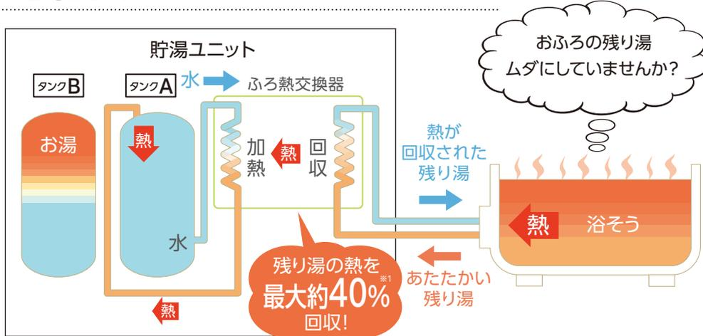
●お風呂の残り湯とタンクの水をふる熱交換器に循環させて、タンクの水を温めます。浴そうのお湯とタンクのお湯は混ぜりません。
