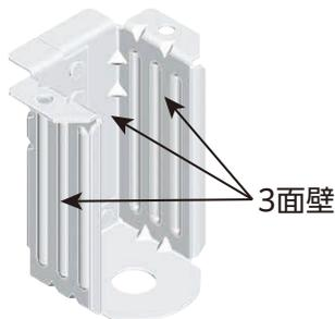
固定脚(前側)を3面壁構造とすることで、強度確保。
