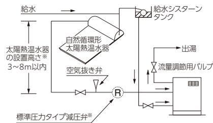
※太陽熱温水器と機器の落差は3m以上8m以下にしてください。機器への給水圧が0.08MPaを超える太陽熱温水器(直圧式太陽熱温水器や8mを超える高さに取付けられた場合は、減圧弁を途中に入れて機器に接続してください。)
