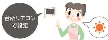
翌日が晴れの場合、リモコンで設定すると夜間の沸き上げ量を減らして、翌日の昼間に太陽光発電の余剰電力で沸き上げを行います。
