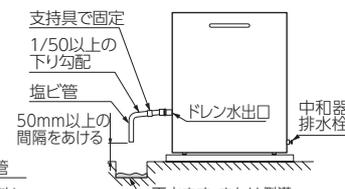
ガス給湯器(GKタイプ)と自然循環式太陽熱温水器接続時の注意点
