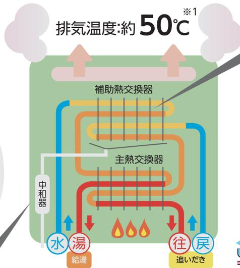
約200°Cになった排気熱を、補助熱交換器で再利用して水を温めます。
