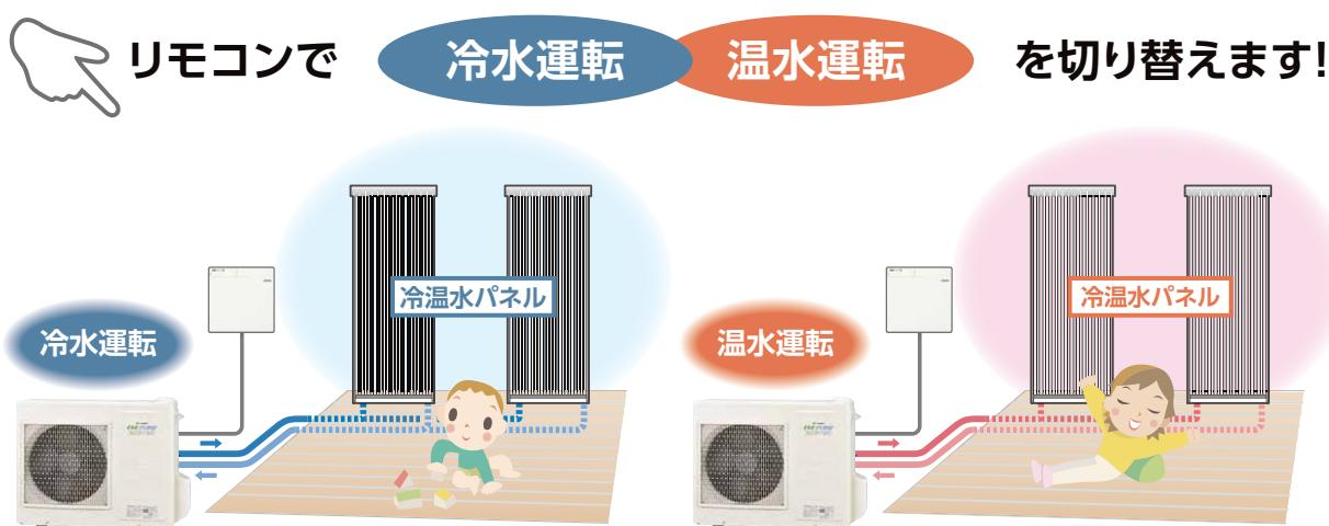
**注意** • 冷水の使用は、結露対策が施された冷水専用端末の選定が必要です。 • 密閉回路方式に変更すると、鉄製パネルヒーターなどの放熱器が使用できます。
