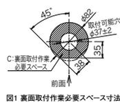
図1 裏面取付作業必要スペース寸法
