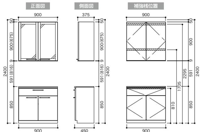
※本図はガラス吊戸棚の場合を示します。※( )寸法は、化粧吊戸棚の場合です。※化粧吊戸棚には9mmのスチームガードパネルは付属されません。
