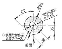
図1 裏面取付作業必要スペース寸法(1.5)
