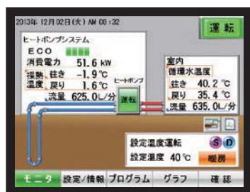
〈メインモニター〉 現在の運転状態の表示
