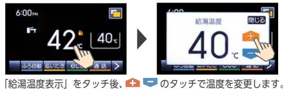
「給湯温度表示」をタッチ後、+、- のタッチで温度を変更します。
