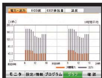
〈グラフ〉 ヒートポンプ・採熱ポンプ・ 冷暖房ポンプの電力と、 出力を48時間分表示
