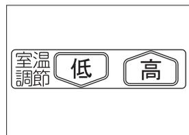
自動運転では消火は行わないため、比較的暖かい時期や設置条件によっては設定温度より室温が上がる場合があります。この場合はセーブ運転をご使用ください。燃焼・消火を繰り返し、室温を調節します。(22ページ参照)
